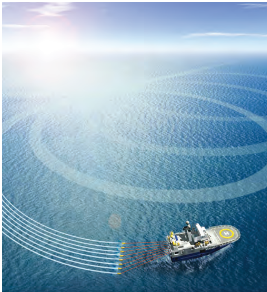
Barco navegando em trajetória circular para aquisição sísmica por meio da técnica de Coil Shooting
