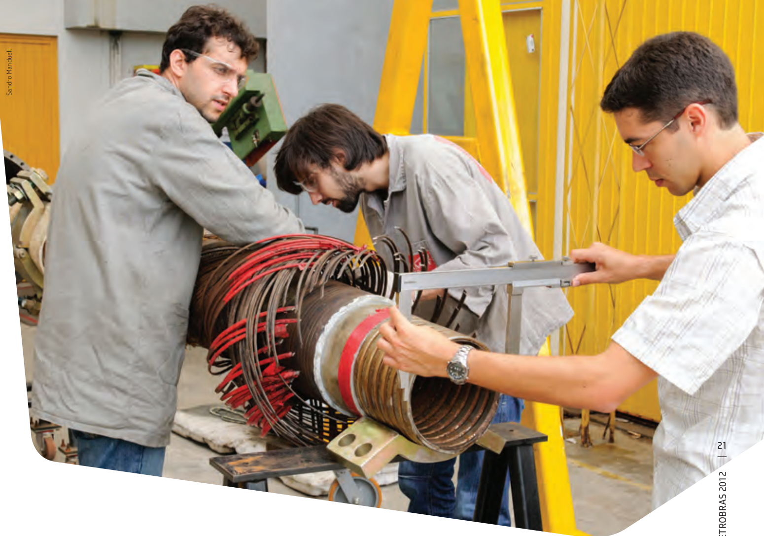
Teste na UFRGS em riser flexível com montagem sem dobramento
