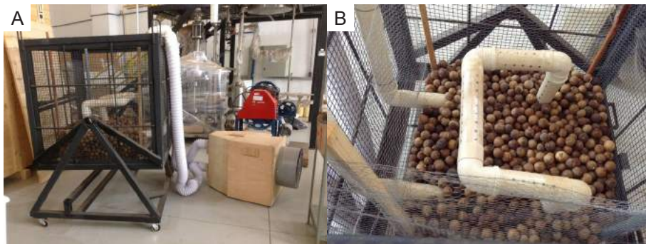
Figura 6. Vista lateral (a) e superior (b) do protótipo de sistema de armazenamento em condições de temperatura ambiente e ventilação forçada.
