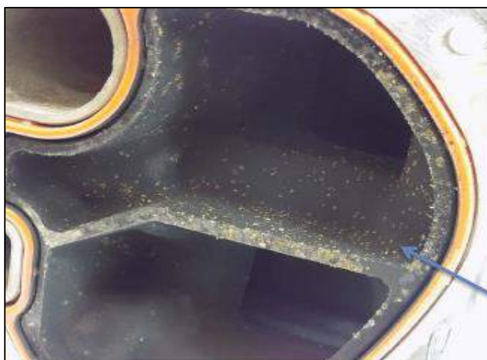
Figura 9: Conduto internos da Válvula EGR.
