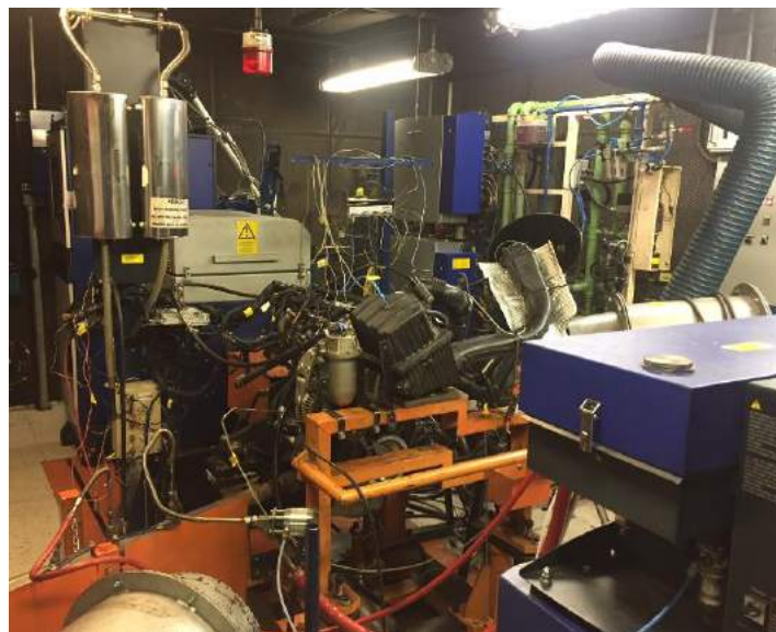
Figura 1: Motor Fiat 2.0l instalado no dinamômetro.
